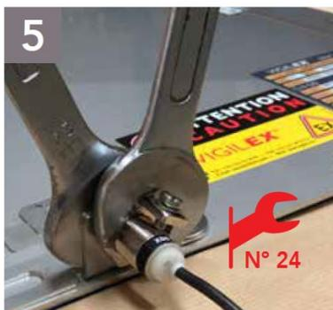
Com 2 chaves de boca No 24, aperte a porca de fixação para prender o sensor.
